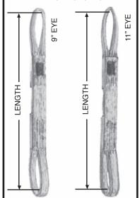
MEDIUM DUTY SINGLE PLY BODY WEAR STRIP ONE SIDE FULL LENGTH HEAVY DUTY DOUBLE THICK WEAR STRIP ONE SIDE FULL LENGTH
